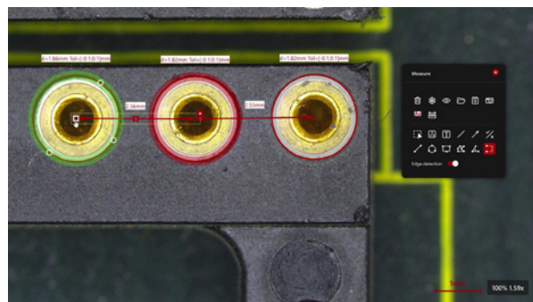
Enersight로 사용자 지정 오버레이를 화면에 직접 만들고 저장합니다. 오버레이로 작업하면 특히 부품이나 구성요소가 지정된 공차 내에 있는지 확인하는 등의 반복 작업에 유리합니다.
